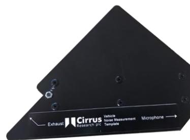
Halten Sie die Schablone an den Auspuff am entsprechenden Ausschnitt und fahren Sie die Antenne aus, um sicherzustellen, dass das Mikrofon richtig positioniert ist.
