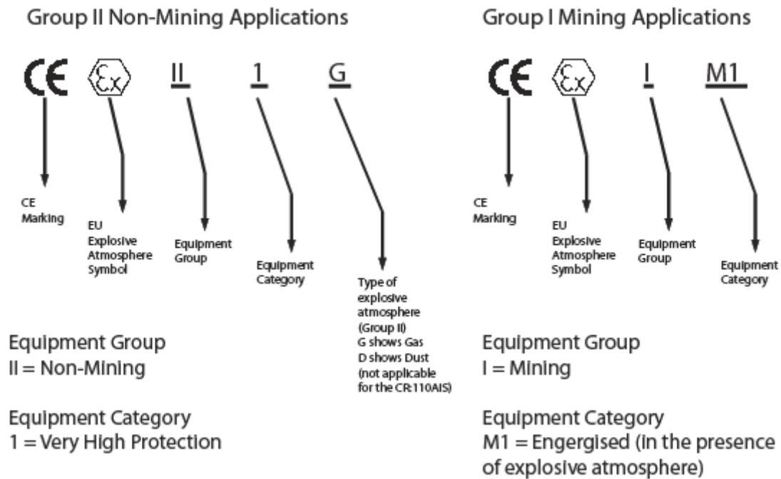
Da sich die ATEX-Richtlinie von der IEC/CENELEC-Zertifizierung unterscheidet, werden für die Eigensicherheits-Zulassung unterschiedliche Nummern verwendet. Diese werden im Folgenden beschrieben.
