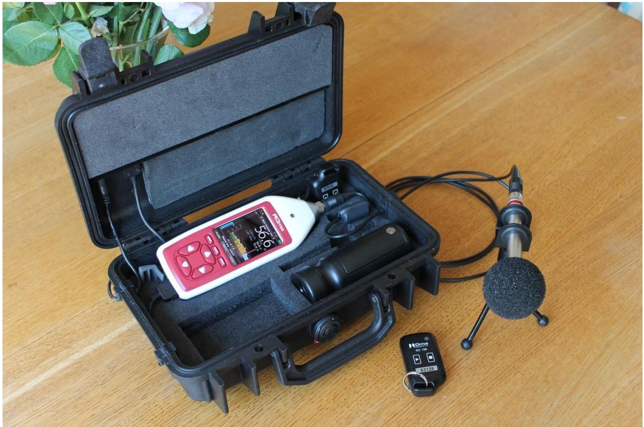
Abbildung 4: Schallpegelmesser Cirrus Optimus Trojan im offenen Koffer Figure 4: Sound level meter Cirrus Optimus Trojan in open case
